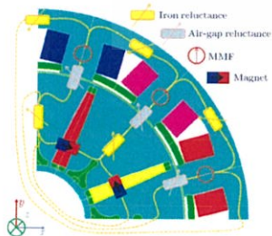
รูปที่ 2.1 โครงสร้างภายในเครื่องจักรซิงโครนัสแบบใช้แม่เหล็กถาวร
