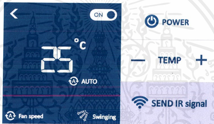
รูปที่ 4.15 หน้าจอสัมผัสเมื่อ SEND สัญญาณของเครื่องปรับอากาศผ่านหน้าจอ
