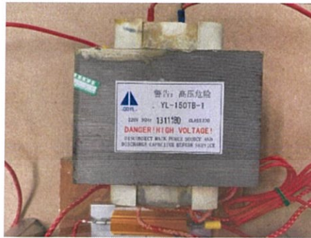
รูปที่ ข.1 Transformer
