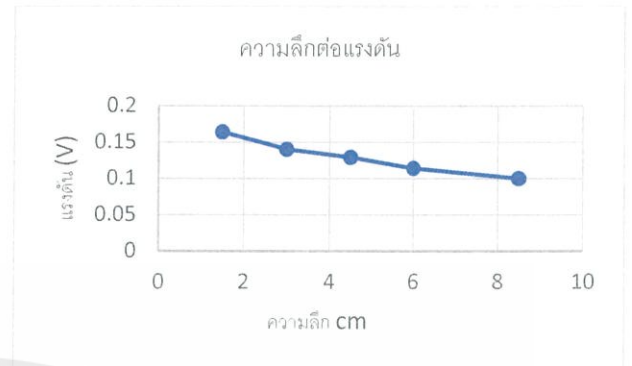
รูปที่ 4.2.3 กราฟเปรียบเทียบเมื่อวัดแรงดันไฟฟ้ารั่วไหลในน้ำในบริเวณที่มีระดับความลึกมีความต่างกัน
