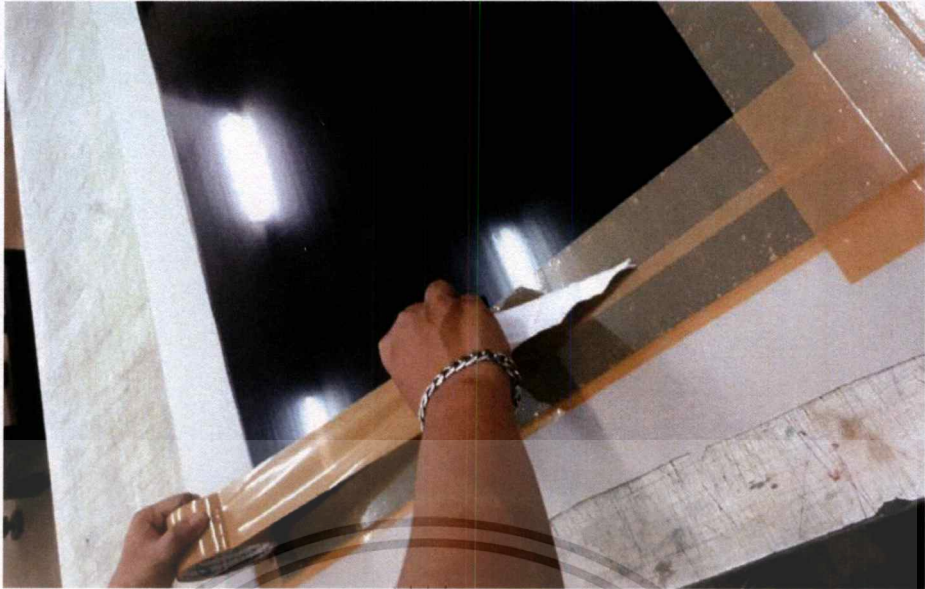
ภาพที่ 3.19 ภาพการปิดเทปกาว การปิดด้านหลังเพื่อกันน้ำกรดกัดหน้าเพลทอย่างแน่นหนา
