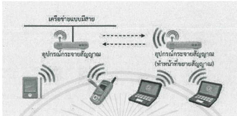
รูปที่ 2.27 รูปแบบการเชื่อมต่อแบบ Use of an Extension Point
