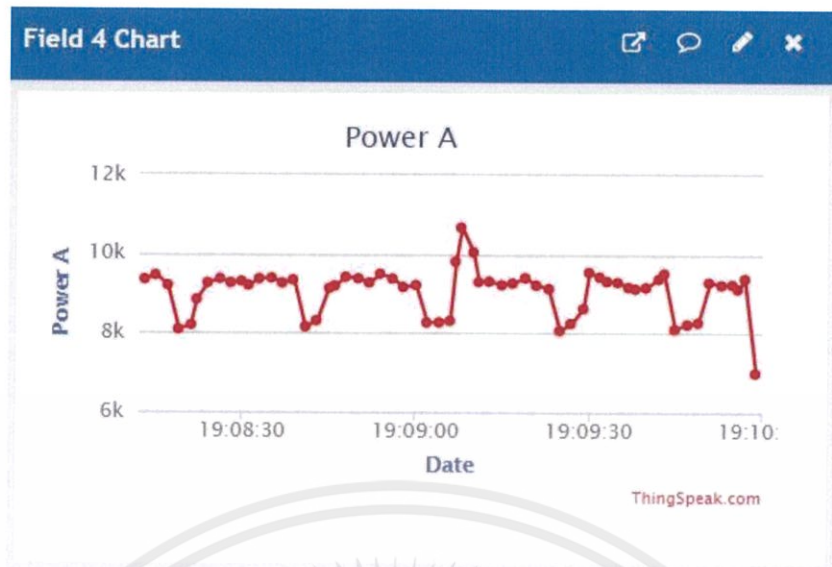
รูปที่ 4.12 กำลังไฟฟ้าจริงเฟส A บน ThingSpeak
