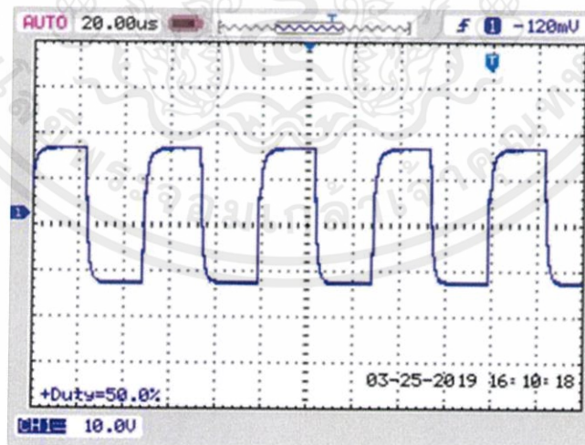
รูปที่ 4.19 รูปคลื่นสัญญาณขับสวิตช์ที่ตีวตีไซเคิลเท่ากับ 50 เปอร์เซ็นต์
