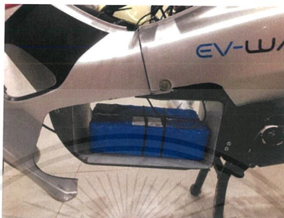
รูปที่ 4.15 ตำแหน่งของแบตเตอรี่
