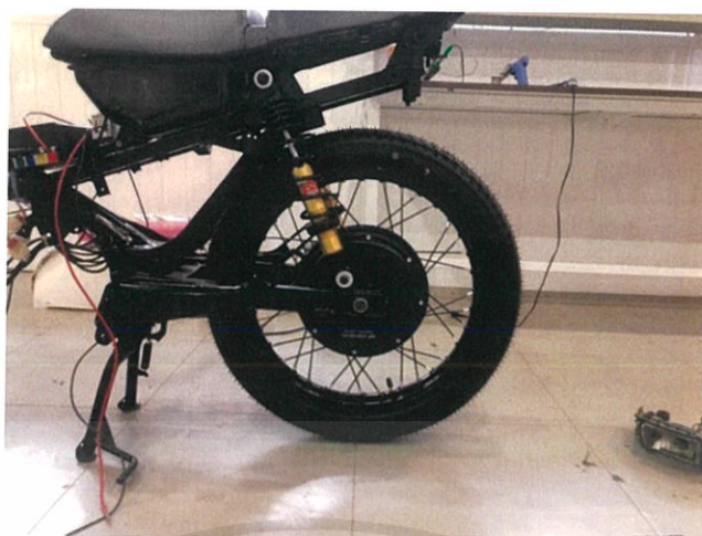
รูปที่ 4.12 มอเตอร์ไฟฟ้ากระแสตรงชนิดไร้แปรงถ่าน (Hub Motor)
