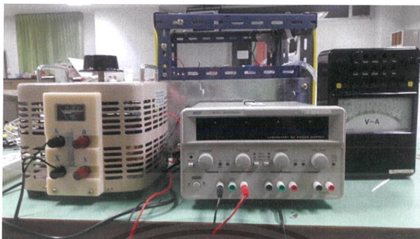
รูปที่ 3.3 เครื่องมือวัดและแหล่งจ่ายไฟฟ้าในการทดลอง
