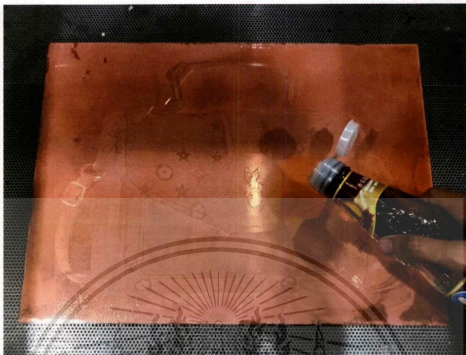
ภาพที่ 3.69 ขั้นตอนการล้างแม่พิมพ์ด้วยซีอีว 3.2.7.8 นำเพลทไปล้างด้วยซีอีวเพื่อความใสสะอาดและมองเห็นได้ง่าย
