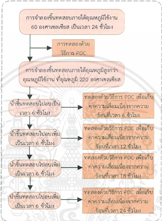
รูปที่ 3.20 แผนภูมิแสดงขั้นตอนการจำลองการเสื่อมสภาพของขึ้นทดสอบจากมอเตอร์ด้วยความร้อนที่อุณหภูมิ 220 องศาเซลเซียส
