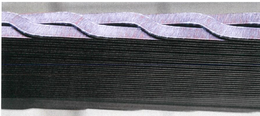
รูปที่ 2.8 การวางแท่งทองแดงด้วยวิธี Transposition ภายในแท่งสเตเตอร์แบบโรเบล [6]
