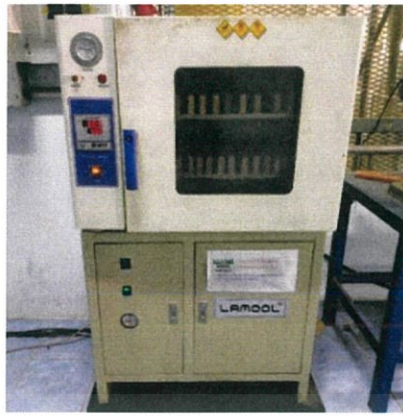
รูปที่ 3.4 เครื่องอบจำลองความเสื่อมสภาพของฉนวน
