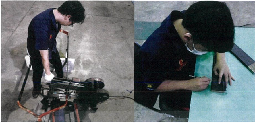
รูปที่ 3.2 การตัดแบ่งชิ้นทดสอบจากเจนเนอร์เตอร์ และ การปลอกชิ้นคอนดักทีฟเทป
