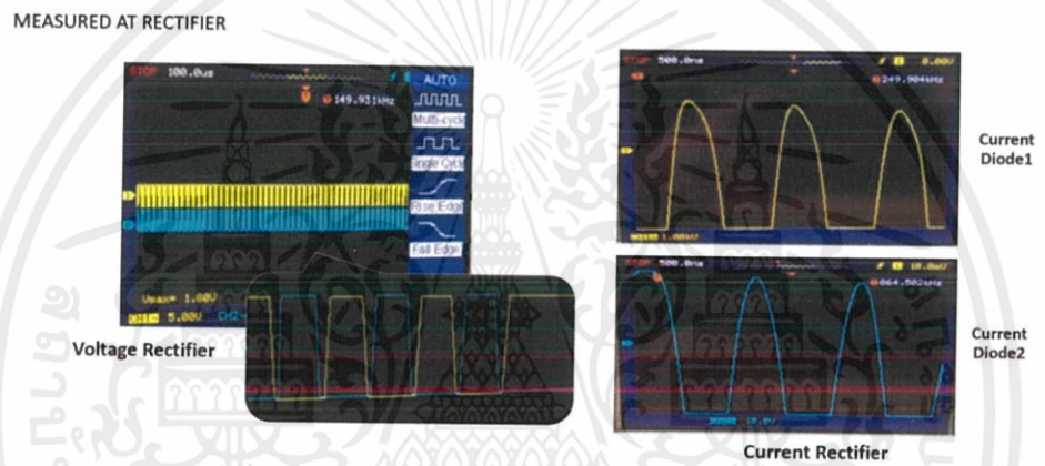
รูปที่ 4.10 การทดสอบวงจรเรกติไฟเออร์ภายในเครื่องชาร์จรถยนต์พลังงานไฟฟ้า แรงดันและกระแสขาออก
