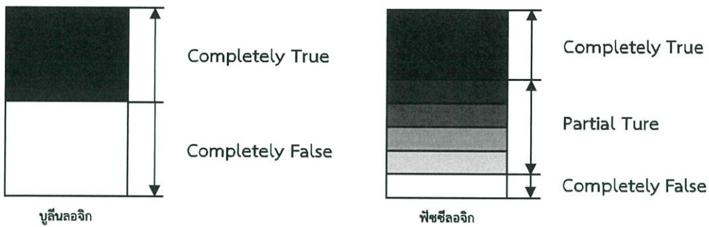
รูปที่ 2.21 การเปรียบเทียบบูลีนลอจิกกับฟัซซีลอจิก
