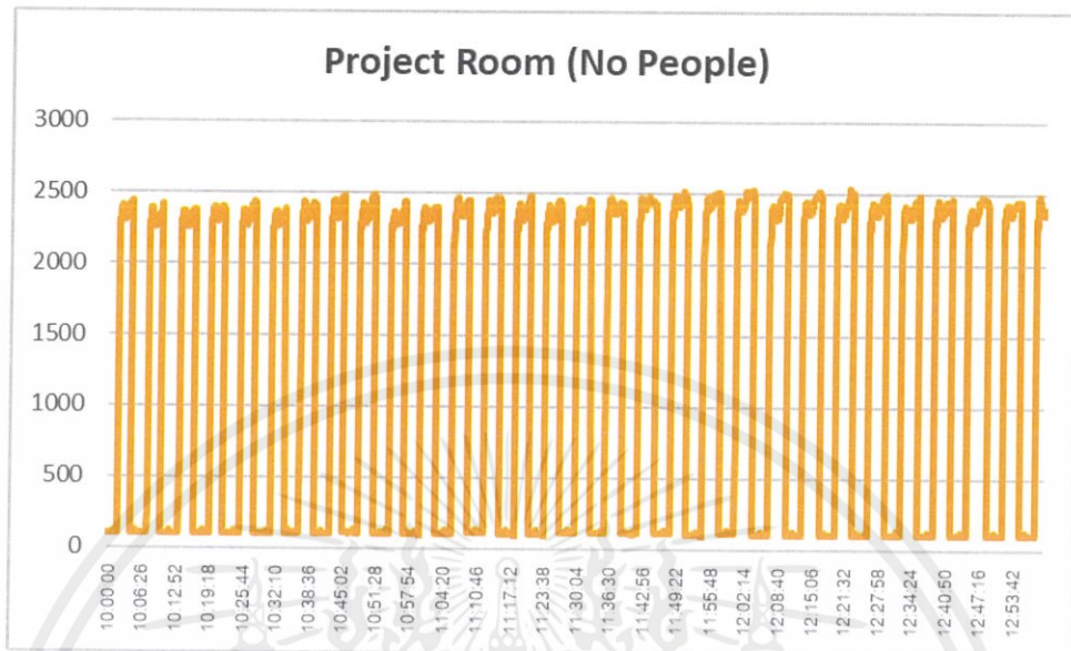
รูปที่ 4.4 ค่าพลังงานเครื่องปรับอากาศ Project Room วันที่ 31 มีนาคม 2562 เวลา 10.00-13.00 น.
