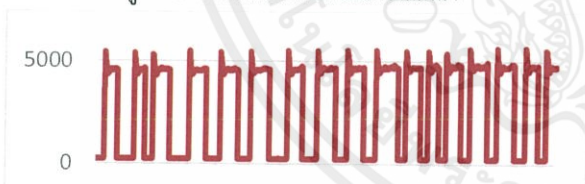
รูปที่ 6 การตัดคอมเพรสเซอร์หลังฉีดน้ำ
