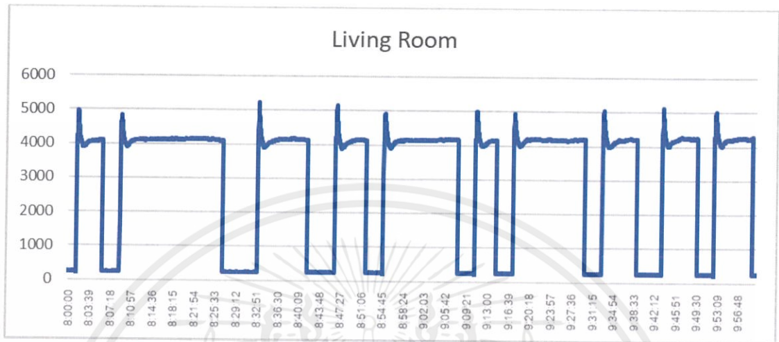
รูปที่ 4.21 ค่าพลังงานเครื่องปรับอากาศ Living Room วันที่ 15 เม.ษ. 2562 วิธีการฉีดน้ำ+กันห้อง เวลา 8.00-10.00 น.
