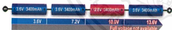
รูปที่ 2.4 การต่ออนุกรมของแบตเตอรี่เมื่อมีเซลล์เสียหาย
