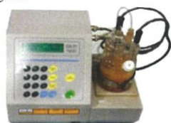
Fig. 5. Karl Ficher moisture meter CA-21.
