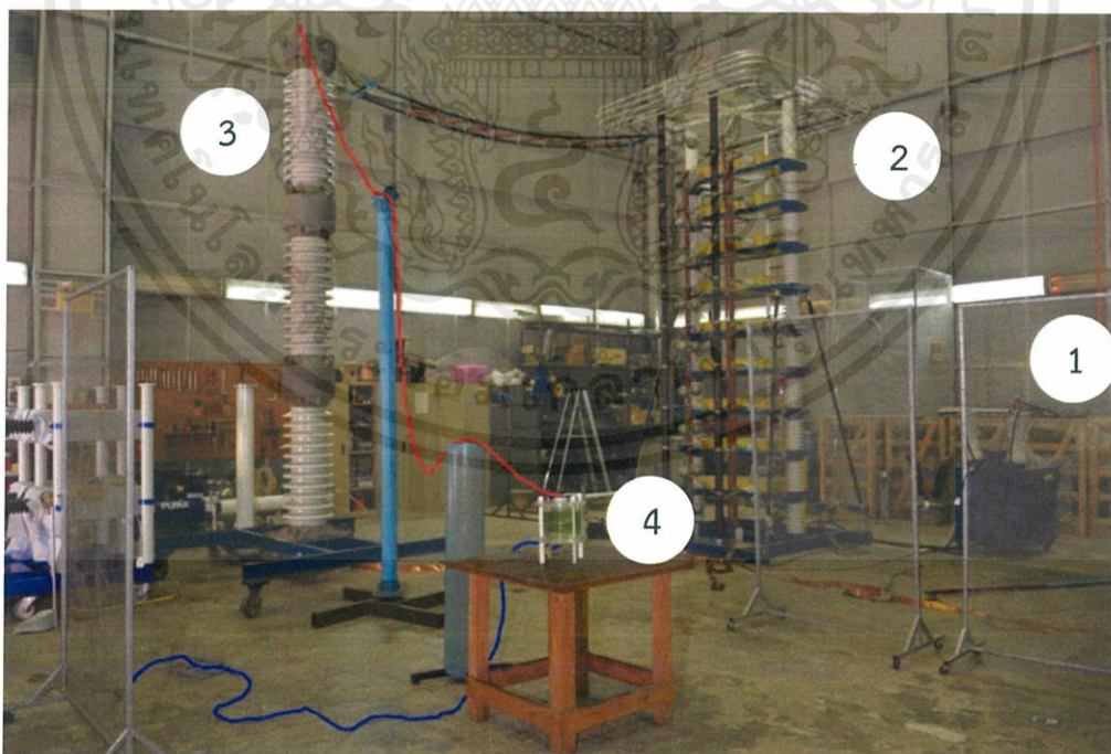
รูปที่ 9 วงจรทดสอบการเบรกดาวน์ด้วยแรงดันไฟฟ้ากระแสสลับของเพอร์สบอร์ดที่ถูกอิมเพกต์ในน้ำมัน โดย 1.ชุดอัดประจุเครื่องกำเนิดแรงดันอิมพัลส์ 2.เครื่องกำเนิดอิมพัลส์ 3.ตัวเก็บประจุโหลด 4.ชุดทดสอบการเบรกดาวน์ของเพอร์สบอร์ดที่ถูกอิมเพกต์ในน้ำมัน
