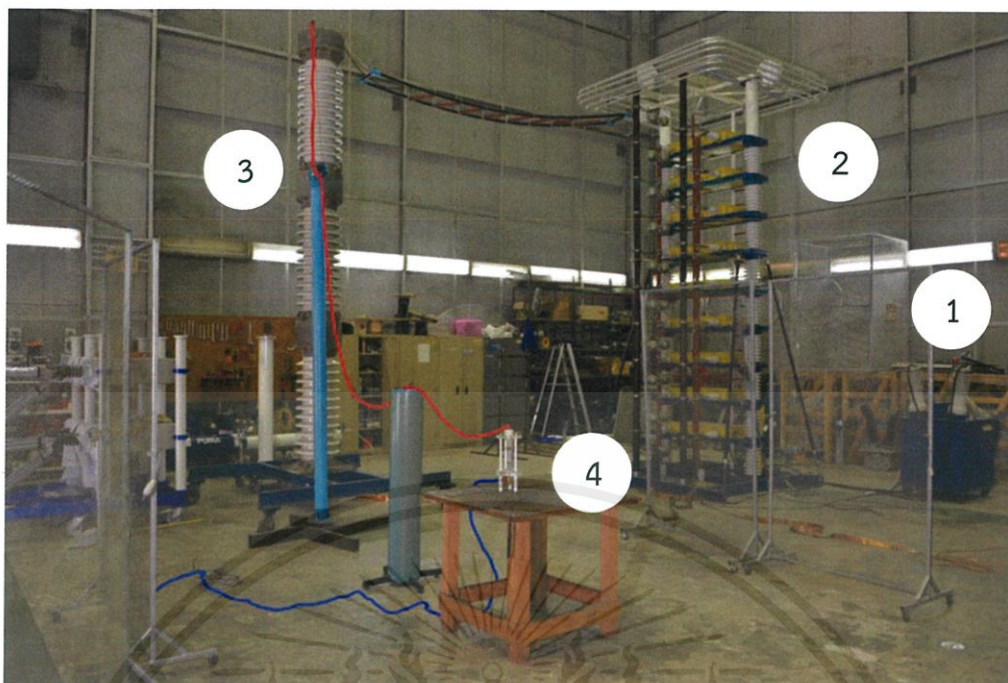
รูปที่ 8 วงจรการทดสอบเบรกดาวน์ด้วยแรงดันอิมพัลส์ฟ้าผ่าของน้ำมัน โดย 1.ชุดอัดประจุเครื่องกำเนิดแรงดันอิมพัลส์ 2.เครื่องกำเนิดอิมพัลส์ 3.ตัวเก็บประจุโหลด 4.ชุดทดสอบการเบรกดาวน์ด้วยแรงดันไฟฟ้าอิมพัลส์ฟ้าผ่าของน้ำมัน
