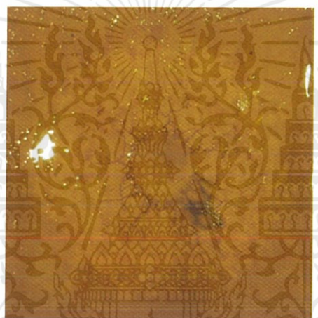
รูปที่ 13 เพอร์สบอร์ดที่ถูกอิมเพรกเนตในน้ำมัน FR3 หลังผ่านการทดสอบแรงดันไฟฟ้ากระแสสลับ
