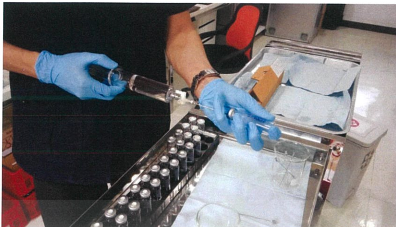
รูปที่ 18 นำน้ำมันจากการทดสอบใส่ไวอัล เพื่อนำไปวิเคราะห์แก๊สที่ละลายในน้ำมัน
