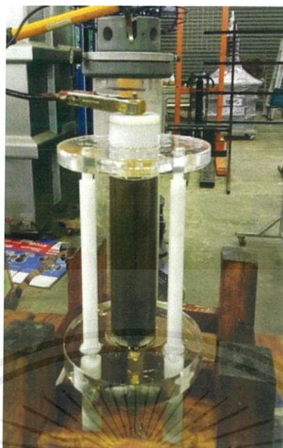
รูปที่ 10 น้ำมันแร่หลังผ่านการทดสอบด้วยแรงดันอิมพัลส์ฟ้าผ่าชั่วคราว (ระยะแก๊ป 20 mm 15 ครั้ง)
