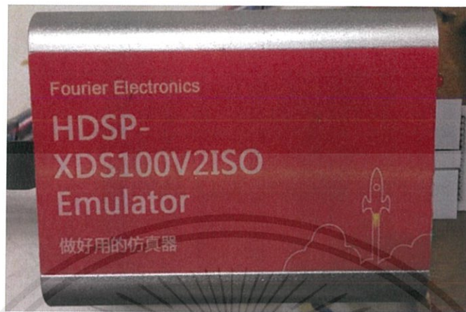
รูปที่ 5.5 อุปกรณ์ Emulator ที่ใช้ในการเชื่อมต่อคอมพิวเตอร์กับไมโครคอนโทรลเลอร์
