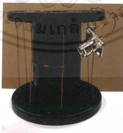
รูปที่ 3.4 อุปกรณ์ขดลวดเหนี่ยวนำแบบแกนอากาศ
