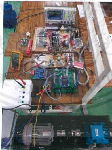
รูปที่ 4.7 เครื่องต้นแบบที่ใช้ในการประมาณค่าฟลักซ์แม่เหล็กโรเตอร์
