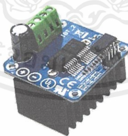
รูปที่ 3. 8 BTS7960 H-Bridge DC Motor Drive (6-27v 43A Max) Module
