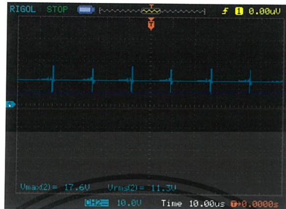
รูปที่ 4.16 รูปคลื่นแรงดันกระแสตรงที่แรงดันตกคร่อมตัวเก็บประจุเท่ากับ 1.3 kV
