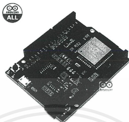
รูปที่ 2.11 Wemos D1 R32 ESP32 Wi-Fi Bluetooth Uno บอร์ด ESP32 แบบ Arduino Uno [50]
