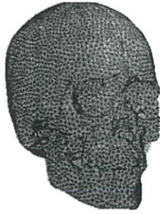
รูปที่ 2.21 รูปแบบจำลองไฟไนต์เอลิเมนต์สำหรับกะโหลกศีรษะ (จากหนังสือไฟไนต์เอลิเมนต์ในงานวิศวกรรม, ปราโมทย์ เตชะอำไพ, 2555) [33]
