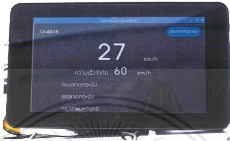
รูปที่ 4.6 หน้าจอขณะอยู่บนถนนทั่วไป ความเร็วน้อยกว่า 55 กิโลเมตรต่อชั่วโมง
