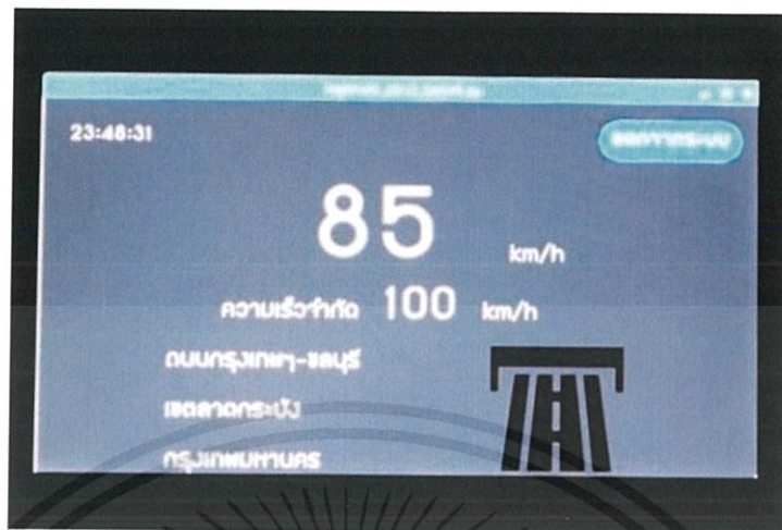
รูปที่ 4.12 หน้าจอขณะอยู่บนทางหลวงพิเศษ ความเร็วต่ำกว่า 95 กิโลเมตรต่อชั่วโมง
