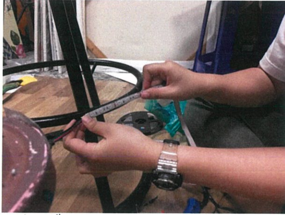
ภาพที่ 15 ขั้นตอนการติดไฟเส้น LED ที่บริเวณขาเก้าอี้
