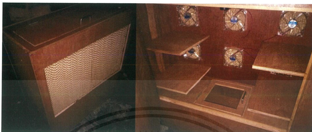
รูปที่ 3.20 ระบบทำความเย็นภายในแบบจำลองตู้จริง
