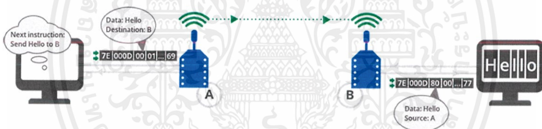
รูปที่ 2.11 แสดงการส่งข้อมูลของ XBee โหมด API [5]
