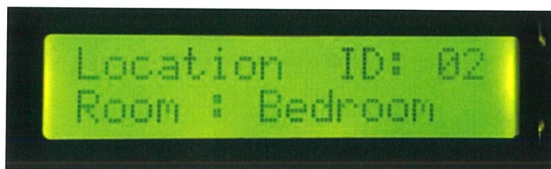
รูปที่ 4.25 ผลบนหน้าจอ LCD เมื่อนำเครื่องระบุตำแหน่งภายในอาคารมาวางไว้บริเวณห้องนอน เมื่อแยกตำแหน่งจากความถี่
