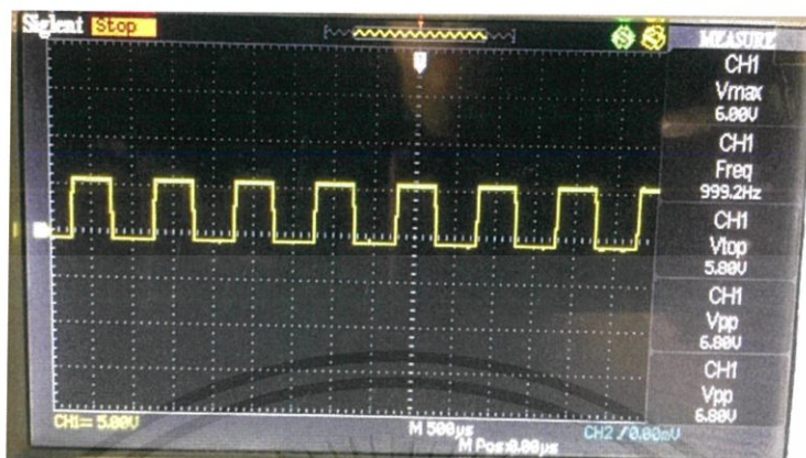
รูปที่ 4.4 สัญญาณเอาต์พุตที่ได้เมื่อระยะทางการรับส่งข้อมูลมีค่า 1.5 m
