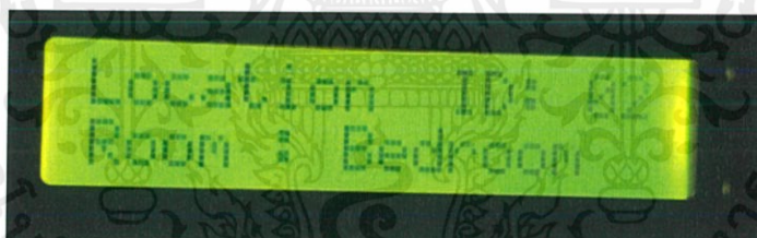
รูปที่ 4.32 ผลบนหน้าจอ LCD เมื่อนำเครื่องระบุตำแหน่งภายในอาคารมาวางไว้บริเวณห้องนอนเมื่อแยกตำแหน่งจากสัญญาณบิตข้อมูลสี่สาร
