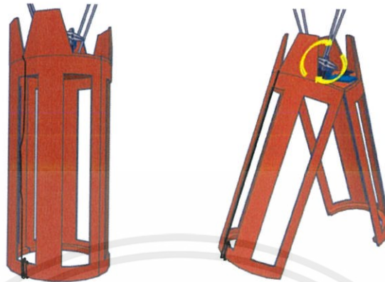
รูปที่ 3.11 กลไกการเปิดออกของส่วนโครงสร้างภายนอก
