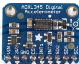
รูปที่ 3.25 เซนเซอร์วัดค่าความเร่งสามแกน (GY-291 ADXL345) [15]
