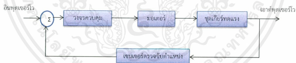
รูปที่ 2.6 บล็อกไดอะแกรมการทำงานของมอเตอร์เซอร์โว
