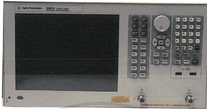
รูปที่ 3.23 เครื่อง Network Analyzer ที่ใช้วัดค่าพารามิเตอร์ต่าง ๆ ของสายอากาศ
