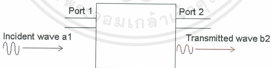
รูปที่ 2.23 S_{21} คืออัตราส่วนของทั้งสองคลื่น b2 / a1
