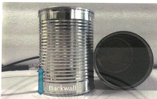
รูปที่ 3.3 ครอบอลูมิเนียมและระยะจากกันครอบเพื่อใส่โพรบ
