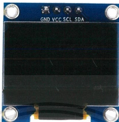
รูปที่ 2.5 จอ OLED 128x64 พิกเซลแบบ I2C
