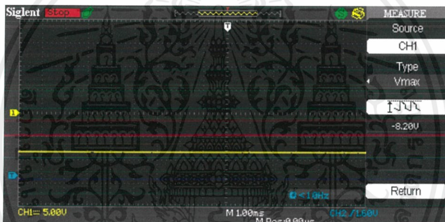
รูปที่ 4.29 ผลลัพธ์หน้าจอออสซิลโลสโคปเมื่อป้อน “-” จ่ายไฟค่าลบเข้าสู่ขดลวด
