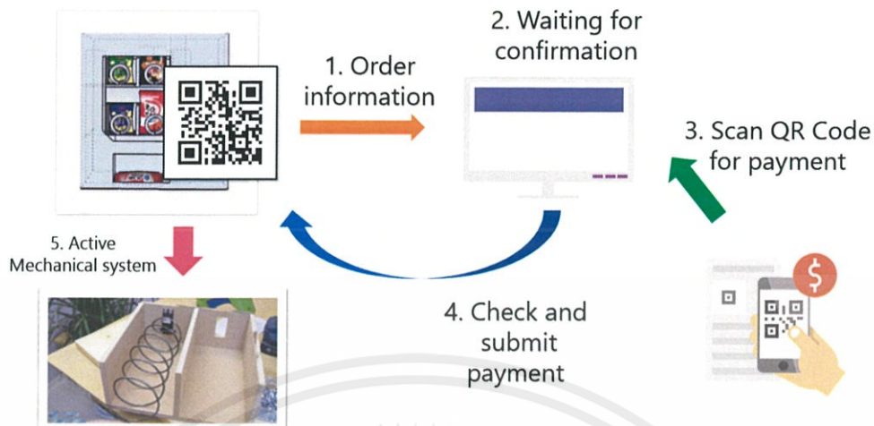
รูปที่ 3.7 หลักการทำงานของระบบการซื้อสินค้าจาก vending machines
