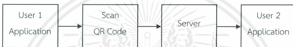
รูปที่ 3.5 บล็อกไดอะแกรมการทำงานของโอนเงินโดย Scan QR Code
