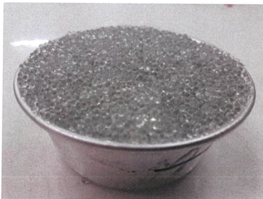
รูปที่ 1.1 เม็ดแก้วที่ผ่านตะแกรงเบอร์ 8 ค้างตะแกรงเบอร์ 16 ( \text{Ø}1.18\text{-}2.36 มม.)
