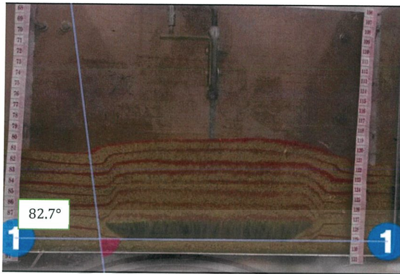
รูปที่ 4.14 แสดงการจำลองการตั้งของแผ่นสมอขนาด 9 x 20 เซนติเมตรที่ระยะฝั่ง 8 เซนติเมตร พบว่าระนาบการพังของดินมีค่า 82.7 องศา
