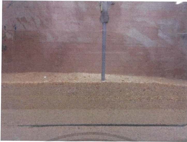
(รูปที่ 3.15 การวางสมอตีดกระจกเพื่อหาตุการยกตัว)
