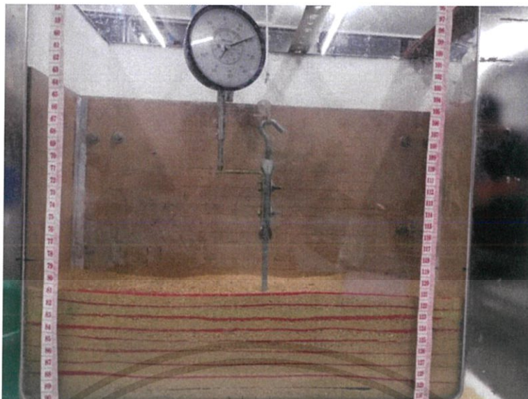
รูปที่ ง.3 การทดลองหาแนวการพิบัติของ สมอขนาด 20x9 cm
