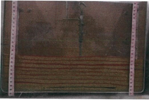
รูปที่ 4.9 แสดงแผ่นสมอที่ถูกกระทำด้วยแรงถอนและมีการเคลื่อนตัวขึ้นจนมีจนเห็นลักษณะได้ชัดเจน
