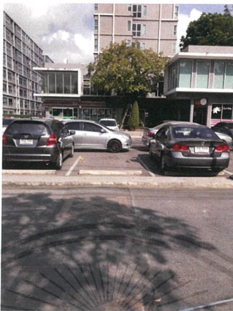
รูป 4.23 แสดงรูปที่จอดรถภายนอกช่องที่จอดรถเป็นแบบตั้งฉากกับทางเดินรถ
