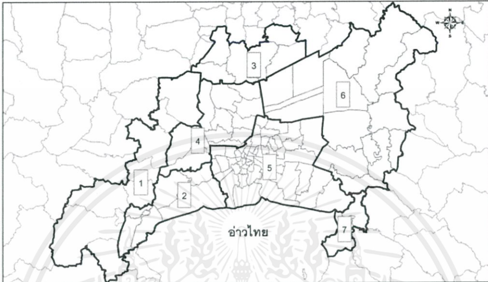
แผนที่แสดงการแบ่งโซนพื้นที่ในกรุงเทพมหานครเพื่อการออกแบบ อาคารด้านทานแผ่นดินไหว
