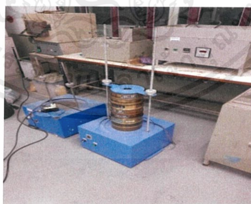
รูปที่ 3.20 นำผักตบที่ปั่นแล้วไป sieve ผ่านตะแกรงเบอร์ 16
