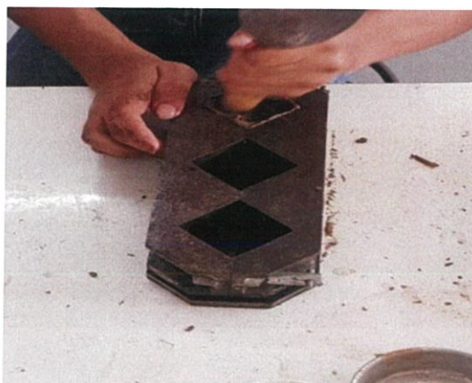
รูปที่ 3.29 ทำการอัดดินที่ผสมแล้วใส่แม่พิมพ์
