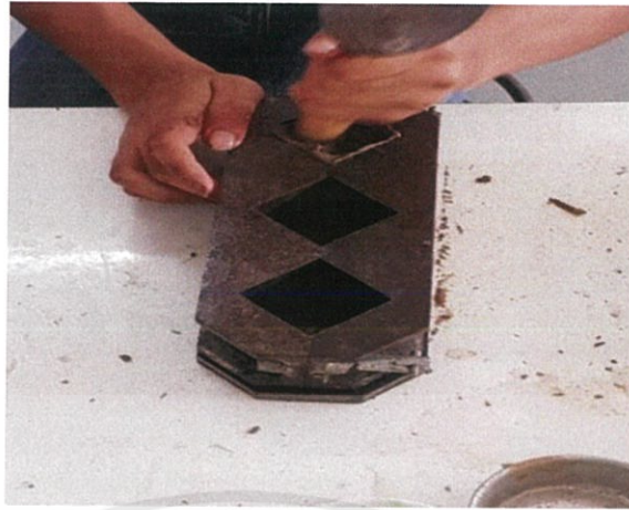
รูปที่ 3.40 ทำการยัดดินที่ผสมแล้วใส่แม่พิมพ์
