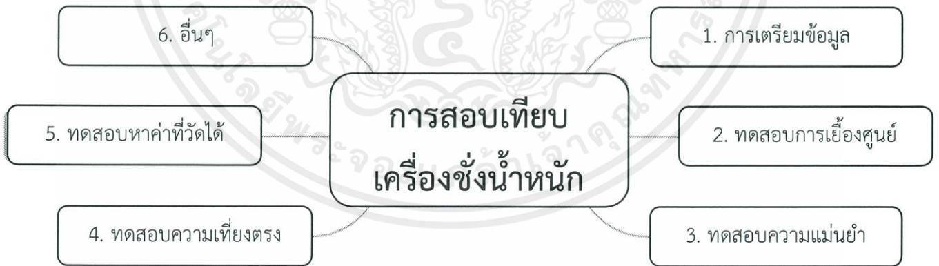
รูปที่3.1 แผนภาพขั้นตอนการสอบเทียบเครื่องชั่ง
