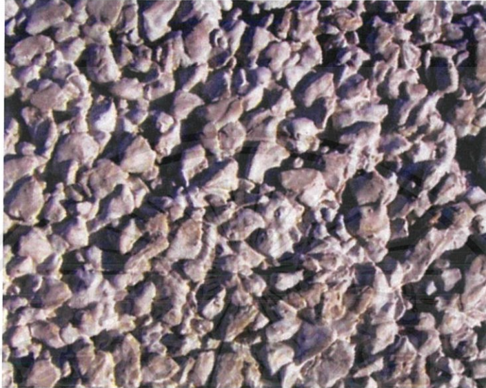
ภาพที่ 2.4 คอนกรีตที่ไม่มีสัดส่วนละเอียด (No-Fines Concrete)
