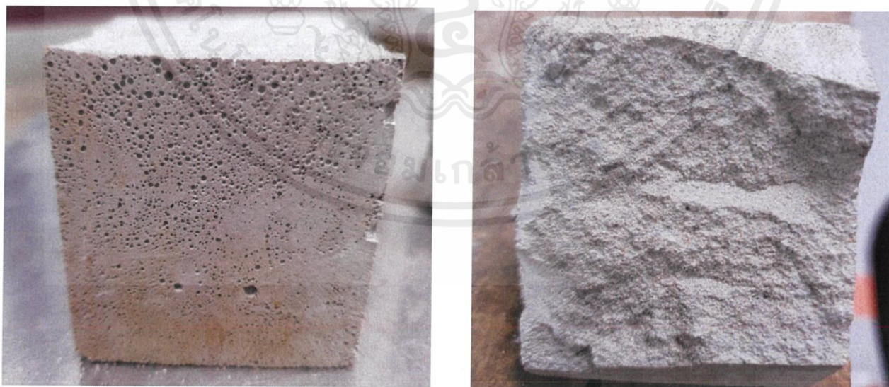
ภาพที่ 4.1 ลักษณะของตัวอย่างที่เวลาในการบ่ม 1 นาที่ (ก) ผิว (ข) ปริมาณฟองโฟมภายใน
