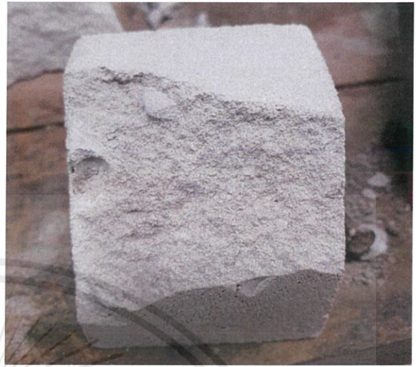
ภาพที่ 4.3 ลักษณะของตัวอย่างที่เวลาในการบ่ม 5 นาที่ (ก) ผิว (ข) ปริมาณฟองโฟมภายใน
