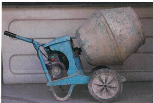
รูปที่ 3.18 ลูกโม่ขนาดเล็ก สำหรับผสมทราย
