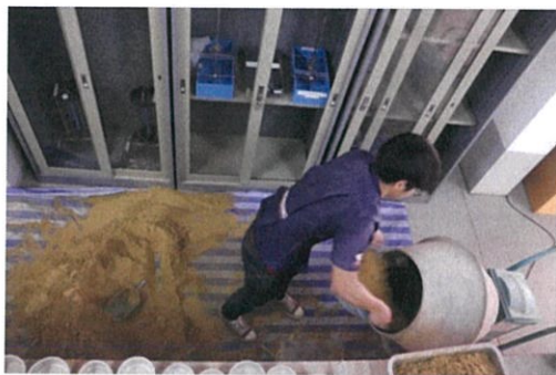
รูปที่ 3.21 การผสมทรายให้ได้ %WT เท่ากับ OMC
