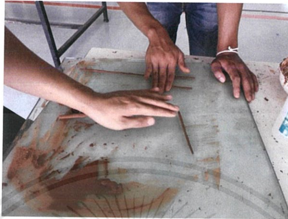
รูปที่ 3.12 แสดงการนำดินมาผึ่งให้หมาดๆแล้วนำมาปั้นคลึงเป็นแท่งยาว
