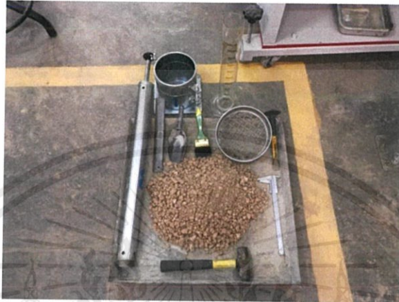
รูปที่ 3.13 แสดงวัสดุและอุปกรณ์การทดสอบการบดอัดดิน
