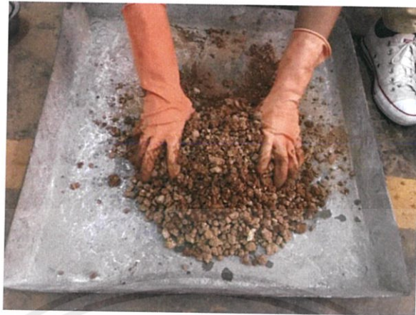
รูปที่ 3.16 แสดงการผสมดินกับน้ำ
