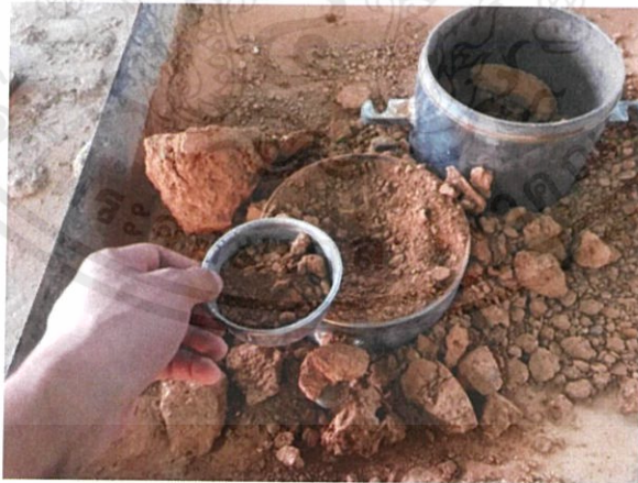
รูปที่ 3.28 แสดงการเก็บตัวอย่างดินเพื่อนำไปหา Water Content
