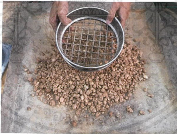
รูปที่ 3.15 แสดงการร่อนดินผ่านตะแกรงเบอร์ 3/4
