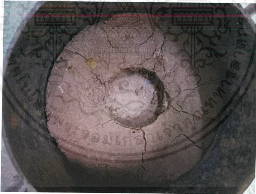
รูปที่ ค.4 แสดงการพืบัติของดินลูกรังประเภท D +LF Slag 10%
