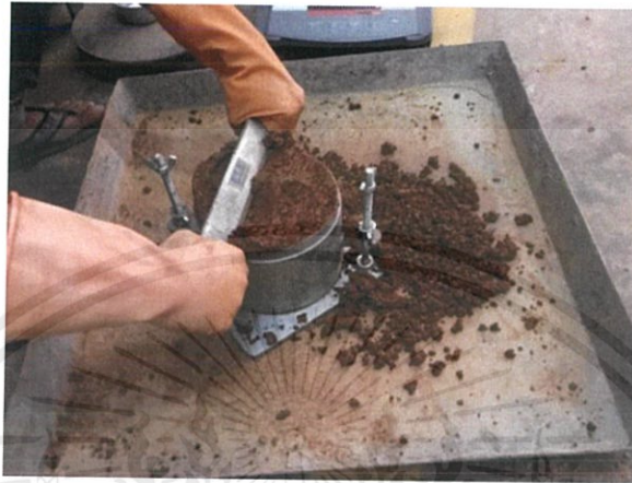
รูปที่ 3.25 แสดงการปาดดินส่วนที่สูงเกินขอบ Mold
