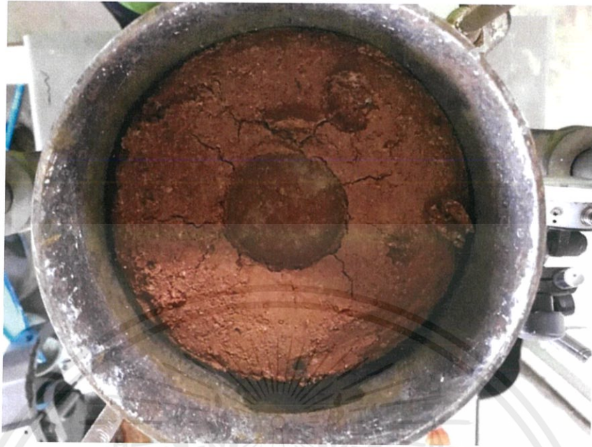
รูปที่ ค.7 แสดงการพิตของดินลูกรังประเภท E +LF Slag 10%
