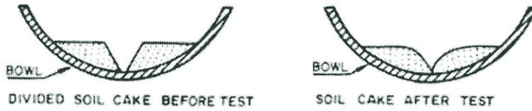
รูปที่ 2.13 การทดสอบพิกัดเหลวเมื่อดินชดกันยาว 1.3 เซนติเมตร
