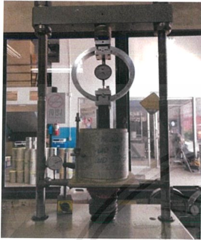
รูปที่ 3.2 รูปการติดตั้ง C.B.R. Test
