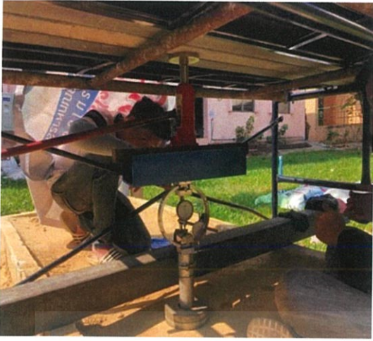
รูปที่ 3.4 รูปการติดตั้ง Field C.B.R. Test
