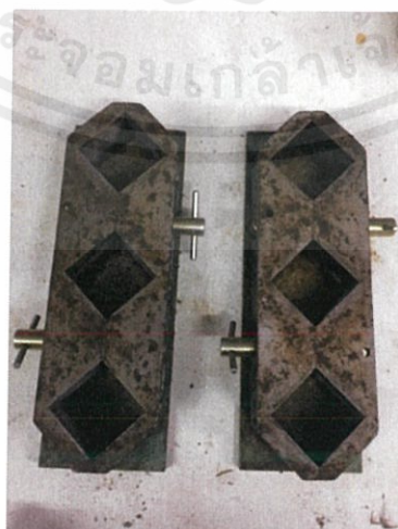
รูปที่ 3.10 แบบหล่อทรงลูกบาศก์ที่ใช้เก็บตัวอย่างขนาด 5x5x5 cm
