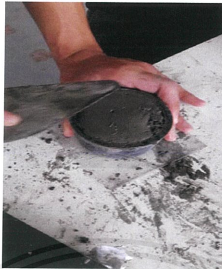
รูปที่ 3.9 ตัวอย่างการเตรียมซีเมนต์เพสต์
