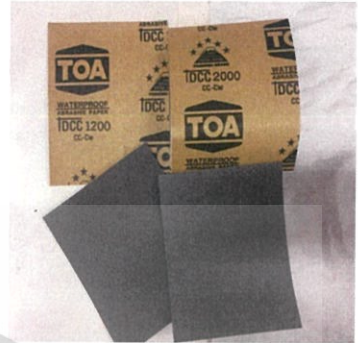
ภาพที่ 3.18 กระดาษทรายน้ำเบอร์ 2000,1200
