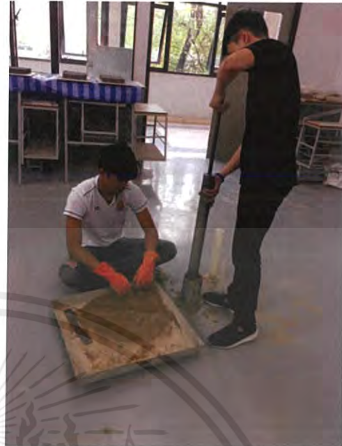
รูปที่ 3.2 รูปการบดอัดดินในการทดสอบ Compaction test
