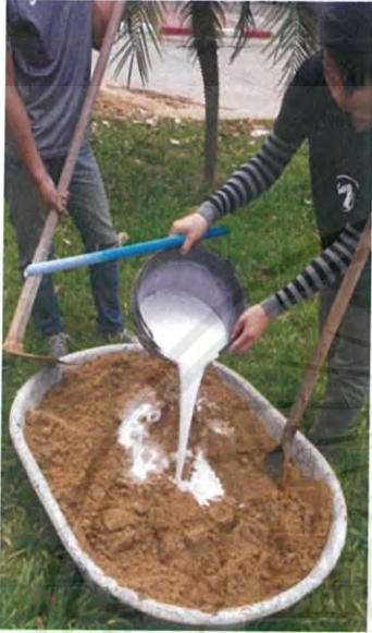
รูปที่ 3.7 รูปการผสมดินเข้ากับสาร Latex ในการทดสอบ Field C.B.R.
