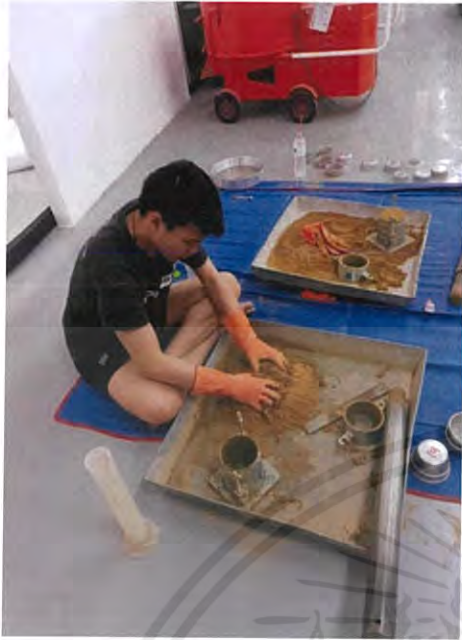
รูปที่ 3.1 รูปการผสมดินกับสาร Latex ในการทดสอบ Compaction test
