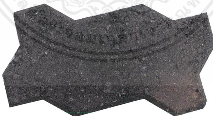
รูปที่ 4.1 ผิวหน้าบล็อกคอนกรีตที่พลาสติกผสม 0.4 เปอร์เซ็นต์ (8.873 กรัม)
