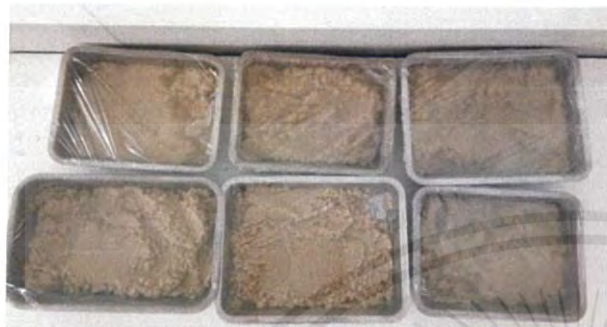
รูปที่ 3.14 การเตรียมตัวอย่างทรายก่อนการบดอัด
