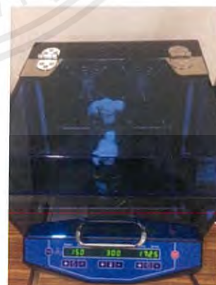
รูปที่ 3.8 การเก็บตัวอย่างแบคทีเรียในเครื่อง Shaking incubator
