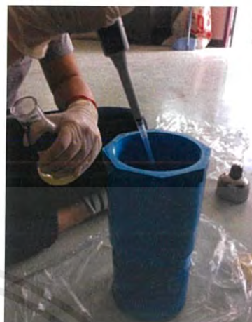
รูปที่ 3.15 การเตรียมตัวอย่างดินในกรณีที่ 2 โดยแต่ละชั้นจะทำการหยดแบคทีเรีย
