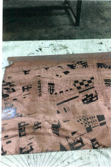
ภาพที่ 3.44 แซ่กรดเสร็จแล้ว นำแม่พิมพ์มาล้าง
