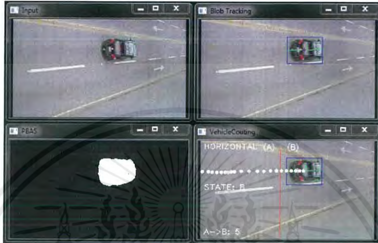
รูป 2.11 ตัวอย่างการทำงานของฟังก์ชันการตรวจจับวัตถุของ OpenCV โดยใช้ BLOB Algorithm (ที่มา : https://github.com/andrewssobral/simple_vehicle_counting , 2015)
